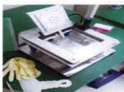
필름과 Array완료된 틀을 접착시킬 Jig장치
